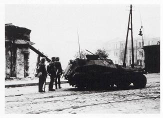
Dans l'organisation de l'artillerie, les commandants de section et de batteries se déplacent dans des véhicules d'observation blindés – à l'instar du Sd.Kfz. 253. Ceux-ci sont progressivement abandonnés, au profit de la pratique des Troupes blindées de conduire depuis les engins de combat.
