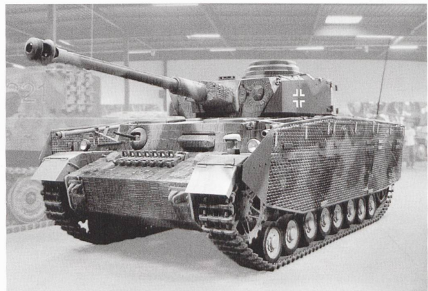
1944-16 Le PzKpfw IV Ausf. J du musée de Saumur montre les limites et l'obsolescence de cet engin, condamné à emporter des blindages grillagés « Thoma » et dépourvu de son moteur auxiliaire d'entraînement de tourelle.
