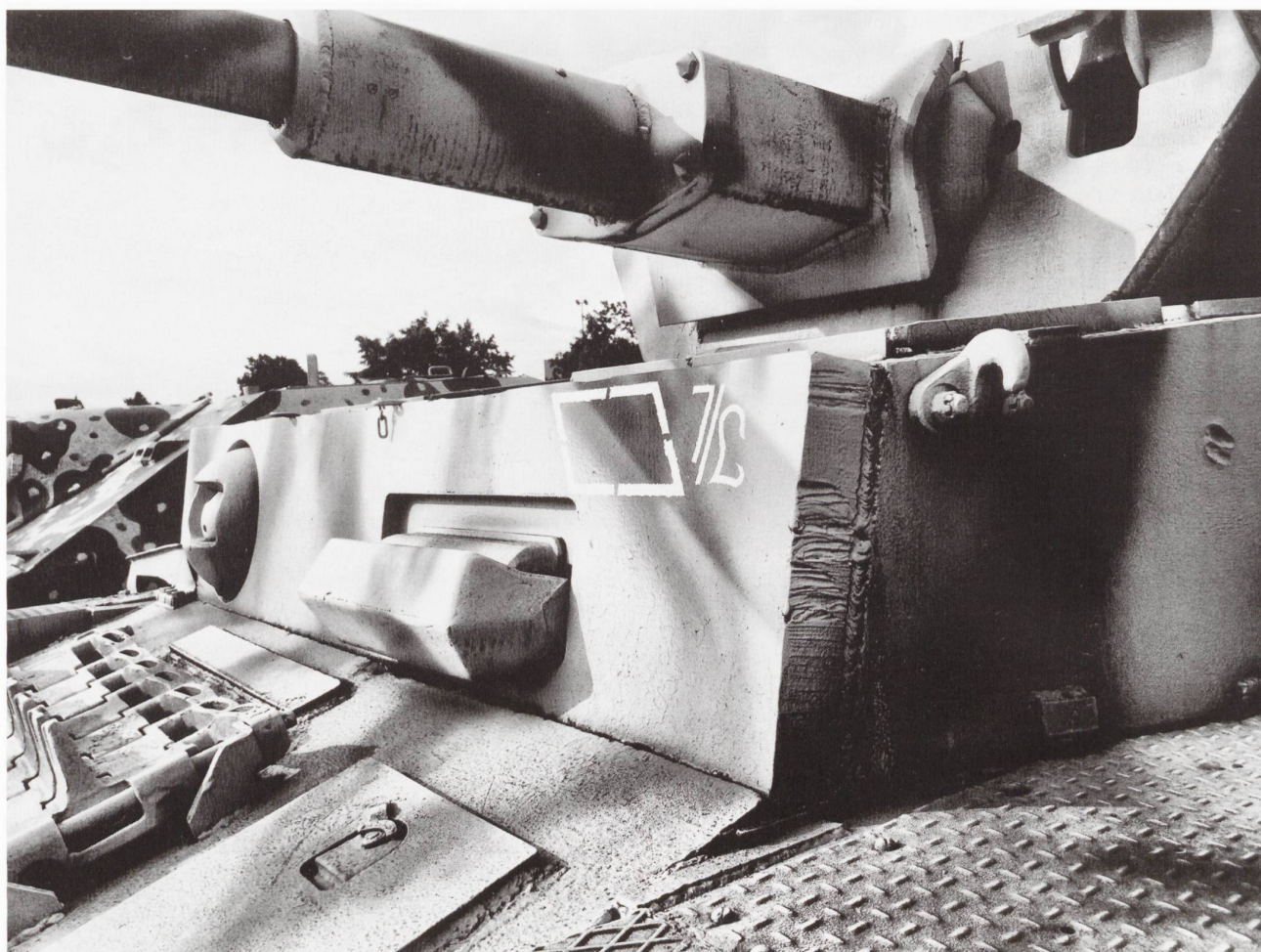
Détails des plaques de blindages supplémentaires boulonnées puis désormais soudées sur la caisse du PzKpfw IV Ausf. G. Cet engin est exposé au musée des blindés de Thoune. Photo © A+V
