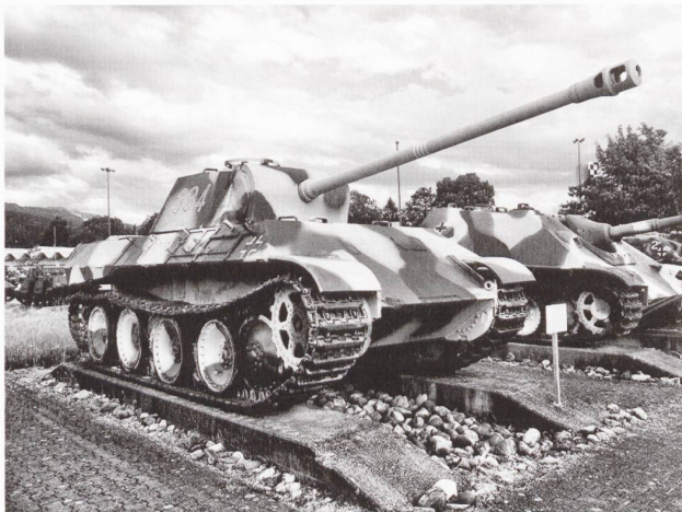
Le PzKpfw V Panther Ausf. A du musée des chars de Thoune. Un système simple permet, sur les côtés, la fixation de « jupes » de blindage supplémentaires. A la mi-1944, le blindage anti-magnétique « Zimmermitt » est abandonné. Photo © A + V
