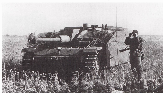
Cette vue d'un StuG III Ausf. F sur le front de l'Est montre bien ses qualités : faible hauteur, fort blindage et tube long.
