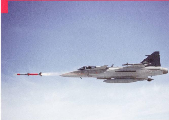
Tir d'un missile *Météor* par un *Gripen E* de présérie. L'engin, conçu par MBDA, pèse 185 kg et peut atteindre sa cible à plus de 100 km de distance. La vitesse est supérieure à Mach 4.
