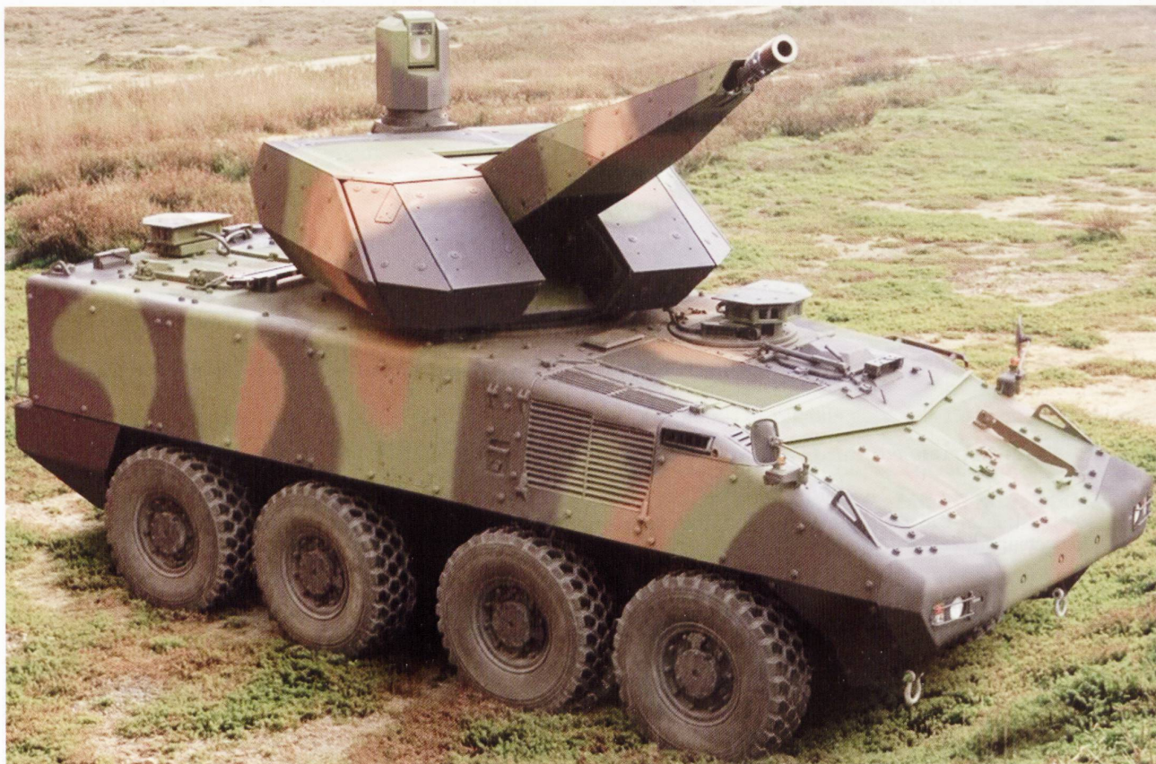
Le Skyranger d'Oerlikon est un système Ahead 35 mm monté sur un châssis de Piranha IV.
