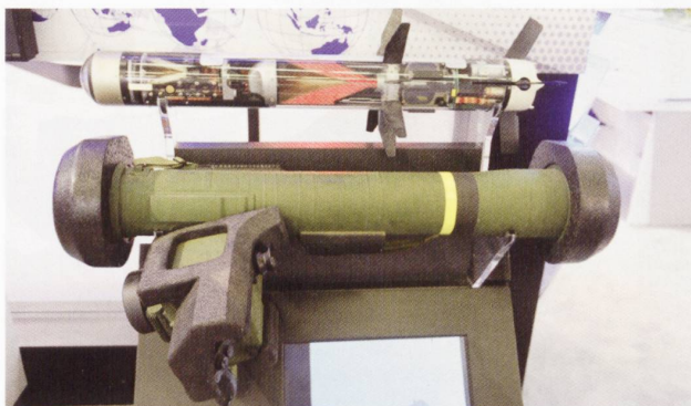
L'engin guidé américain Javelin a été testé dans de nombreux conflits depuis 2004. Il a l'avantage de disposer de plusieurs profils d'attaque (direct ou par le toit).
