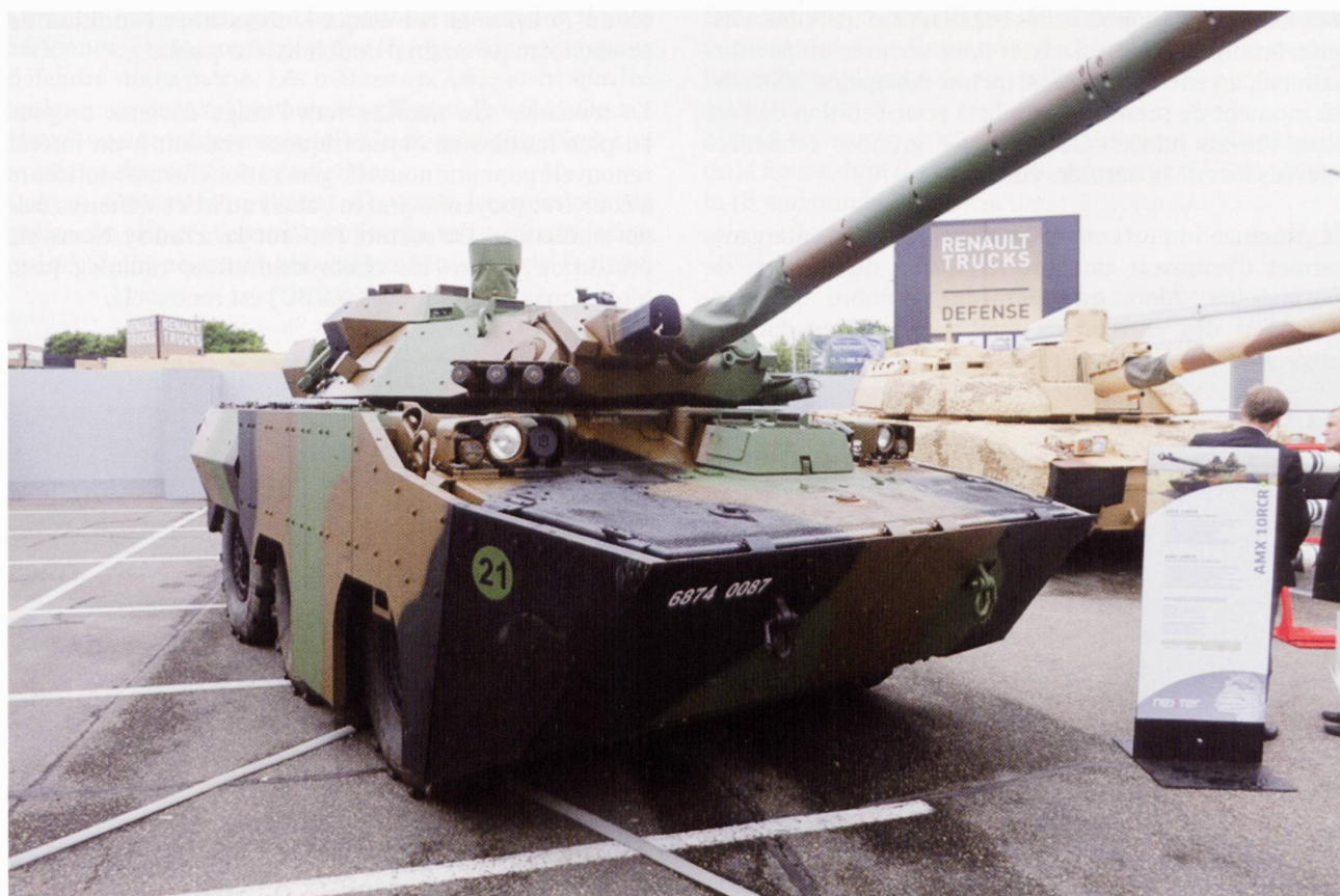
Ci-dessous : L'AMX-10RC avec son kit surblindé passe de 17 à 21 tonnes.
