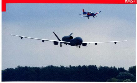
Suivi par un Pilatus PC-9, le premier EuroHawk (99+01) n'est pas un poids plume! Il pèse en effet plus de 6,7 tonnes à vide et mesure 14,5 mètres de long pour 39,9 mètres d'envergure.
