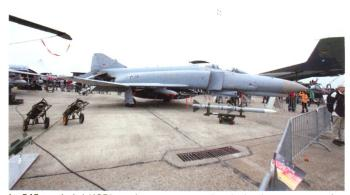
Le F4F revalorisé (ICE) reçoit un nouveau radar ainsi qu'un armement airair sensiblement plus performant, sous la forme de l'AIM-120 AMRAAM présenté sous le ventre de ces deux appareils.
