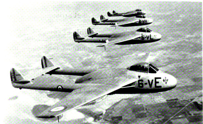
Le Vampire construit sous licence en France, dénommé SNCASE SE 535 Mistral , est reconnaissable à des entrées d'air simplifiées.
