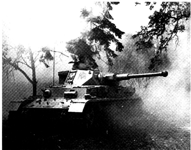
Le PzKpfw IV Ausf. F2 dispose d'un canon de 75 mm « long » de 43 calibres; il est reconnaissable à sa bouche à feu en boule et à une seule ouverture latérale. A partir de l'Ausf. G, le frein de bouche standard à double ouverture du PaK 40 le remplace. Les versions H et J du PzKpfw IV recevront, plus tard, le tube allongé à 48 calibres.
