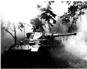
Le PzKpfw IV Ausf. F2 dispose d'un canon de 75 mm « long » de 43 calibres; il est reconnaissable à sa bouche à feu en boule et à une seule ouverture latérale. A partir de l'*Ausf*. G, le frein de bouche standard à double ouverture du PaK 40 le remplace. Les versions H et J du PzKpfw IV recevront, plus tard, le tube allongé à 48 calibres.
