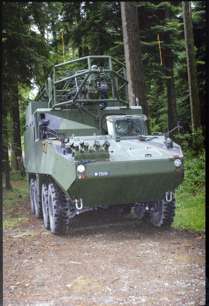
Plusieurs versions spécialisées du Piranha III sont utilisées pour l'aide au commandement: notamment en tant que brouilleur dans les actions de guerre électronique (CGE).
