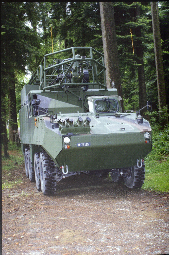
Plusieurs versions spécialisées du Piranha III sont utilisés pour l'aide au commandement: notamment en tant que brouilleur dans les actions de guerre électronique (CGE).
