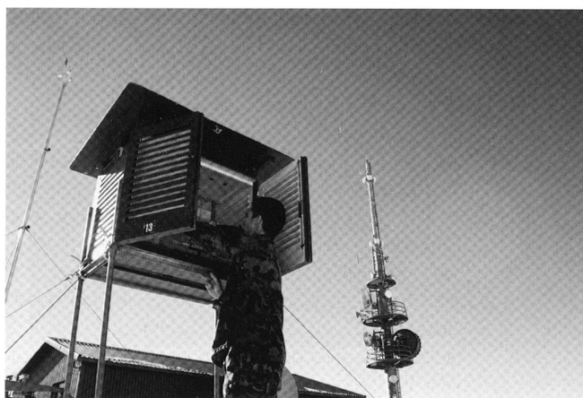
Abri Stevenson pour instruments de mesure météo.
