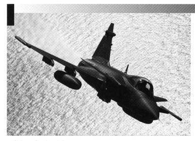
Un JAS-39 C Gripen hongrois en patrouille. Cet appareil peut recevoir jusqu'à trois réservoirs de carburant auxiliaires, afin d'augmenter son autonomie.
