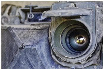
Les véhicules d'exploration sont dotés d'intensificateurs de lumière résideuelle (ILR) et de caméras thermiques (WBG, photo).
