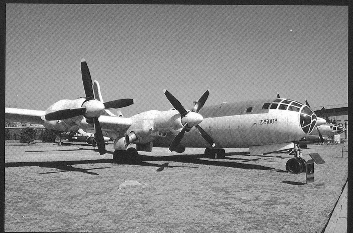
Le Tupolev Tu-4 est la réplique soviétique réalisée à partir du Boeing B-29 américain. L'appareil a pu être réalisé grâce à des épaves de bombardiers américains ayant opéré depuis le Sud de la Chine (nationaliste) dans le cadre de l'opération MATTERHORN. Le Tu-4 a été le premier bombardier soviétique, puis chinois, à pouvoir emporter l'arme atomique. L'appareil de gauche a été transformé en AWACS.
