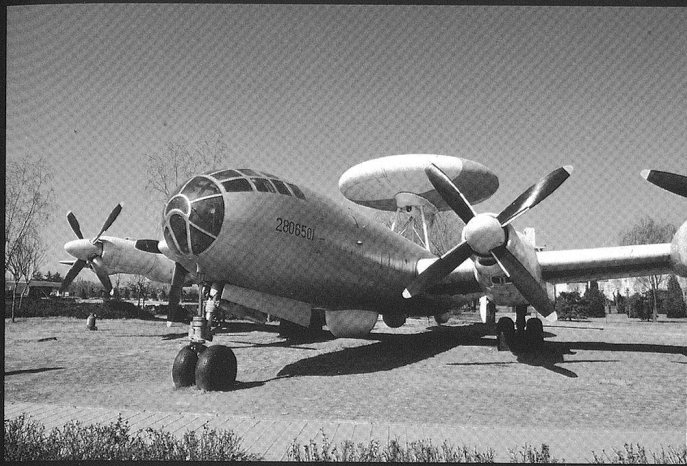
Le Tupolev Tu-4 est la réplique soviétique réalisée à partir du Boeing B-29 américain. L'appareil a pu être réalisé grâce à des épaves de bombardiers américains ayant opéré depuis le Sud de la Chine (nationaliste) dans le cadre de l'opération MATTERHORN. Le Tu-4 a été le premier bombardier soviétique, puis chinois, à pouvoir emporter l'arme atomique. L'appareil de gauche a été transformé en AWACS.
