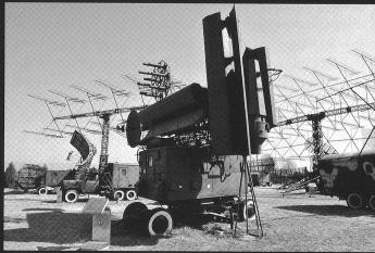
Le musée de la PLAAF présente une grande quantité d'armes de défense contre-avions, de la mitrailleuse jusqu'au missile, en passant par les stations radar. Ici, une batterie de S-75 au complet -comptant quatre à six pièces- est présentée, avec tous ses véhicules tracteurs et ses shelters de commandement. Le S-75 est désigné SA-2 *Guideline* dans l'OTAN. La version chinoise est dénomée *Hong Qi* («Drapeau rouge») HQ-1. La version améliorée, HQ-2, est toujours en service au sein de la PLAAF.
