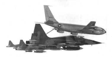
Ces capacités sont mises en oeuvre au Vietnam. Les F-5A sont alors dotés de perches de ravitaillement en vol et de bidons d'extrémités d'ailes. Ils sont renommés F-5C.
