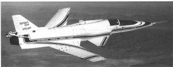
Ci-dessus : Différentes vues du F-20 *Tigershark* développé sur fonds propres par le constructeur Northrop. L'appareil du bas est un prototype dénomé X-29, construit en 1984 et destiné à tester un système de commandes de vol électriques et une voilure inversée, lui donnant une manoeuvrabilité incomparable.
