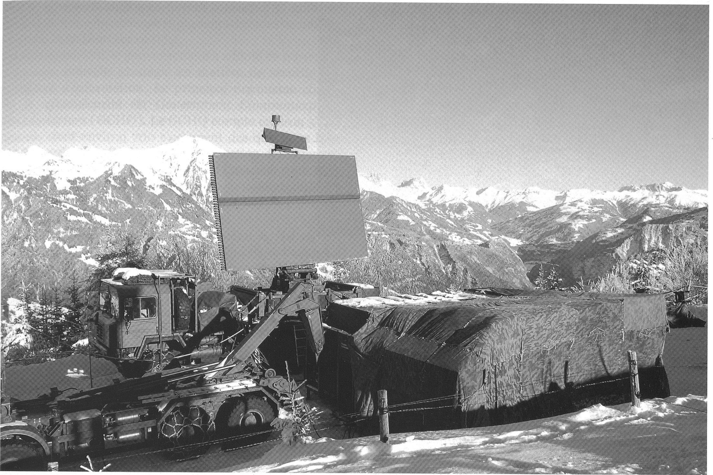
Le système de radar mobile TAFLIR, qui sert à couvrir les zones « d'ombre » des radars FLORAKO. Photo © Forces aériennes.
