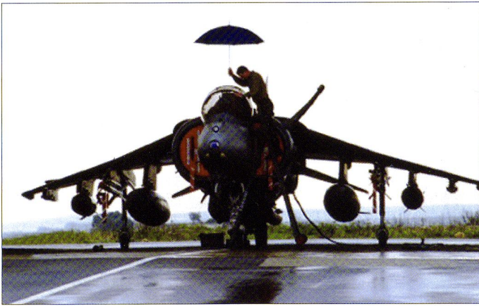
Ce Harrier GR.7 britannique est armé de deux bombes de 454 kg non guidées à sous-munitions (BL 755). La RAF a opéré à partir de bases en Italie ou de ses porte-aéronefs dans l'Adriatique.
