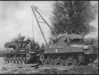
Un M-74 de dépannage dépose le moteur d'un M-47.
