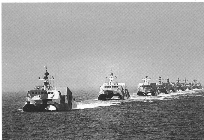
Les chantiers de Qiuxin, près de Shanghai, produisent le navire d'attaque rapide Houbei (Type 022), qui dispose d'une coque catamaran et de caractéristiques furtives.
