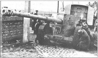
Avec ses 7,4 tonnes et ses 2,10 mètres en batterie, le Flak 18/36 L56 (photo du haut) est une arme destinée à la défense anti-aérienne. Au total, 20'754 sont produits. Le Flak 41, produit à 566 exemplaires, dispose d'un tube plus long (L71) permettant de dépasser les 1'000 m/s de vitesse initiale.
