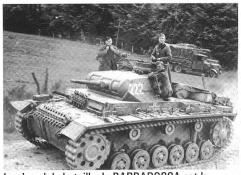
Le cheval de bataille de BARBAROSSA est le PzKpfw III (Sd.Kfz. 141), à l'instar de cet Ausf. E/F, produit en 1939-1940 à 531 exemplaires. Il pèse 19,5 tonnes et emmène 5 hommes, dispose d'un moteur de 300 PS, roule à 40 km/h et peut parcourir 155 km sur un plein.
