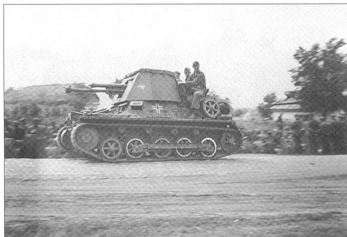
Le Panzerjäger I est armé d'un canon Skoda de 4,7 cm.
