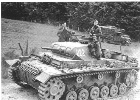
Le cheval de bataille de BARBAROSSA est le PzKpfw III (Sd.Kfz. 141), à l'instar de cet Ausf. E/F, produit en 1939-1940 à 531 exemplaires. Il pèse 19,5 tonnes et emmène 5 hommes, dispose d'un moteur de 300 PS, roule à 40 km/h et peut parcourir 155 km sur un plein.
