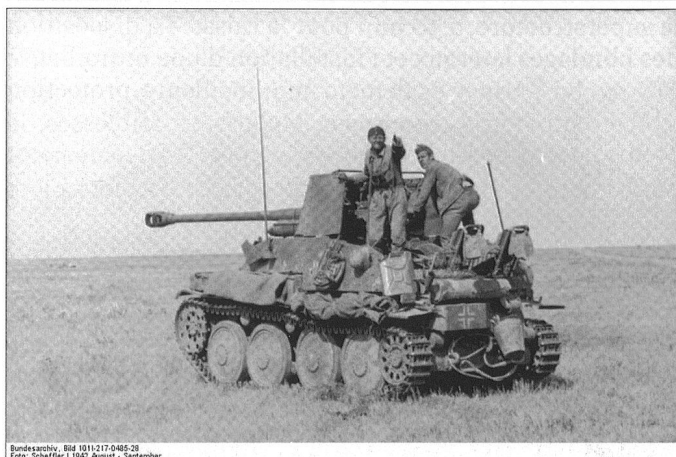
Ci-dessus : Le Marder II est réalisé sur châssis de Pz.Kpfw II ou 38 (t) et emporte le canon soviétique de 7,62 cm.
