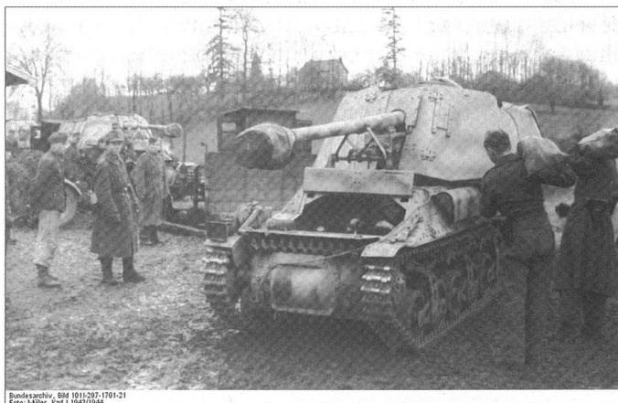
Ci-dessous : Le Marder I est réalisé à partir de châssis français de prise, tel le tracteur à munition Lorraine , et armé du PAK 40 allemand de 7,5 cm.
