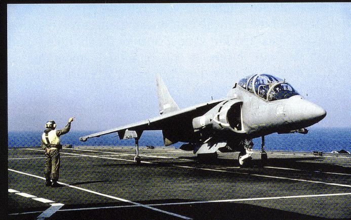
Le Sea Harrier F(A).2 dispose de capacités sensiblement augmentées, grâce à un nouveau radar et à la capacité d'emporter des missiles air-air à moyenne portée AMRAAM.
