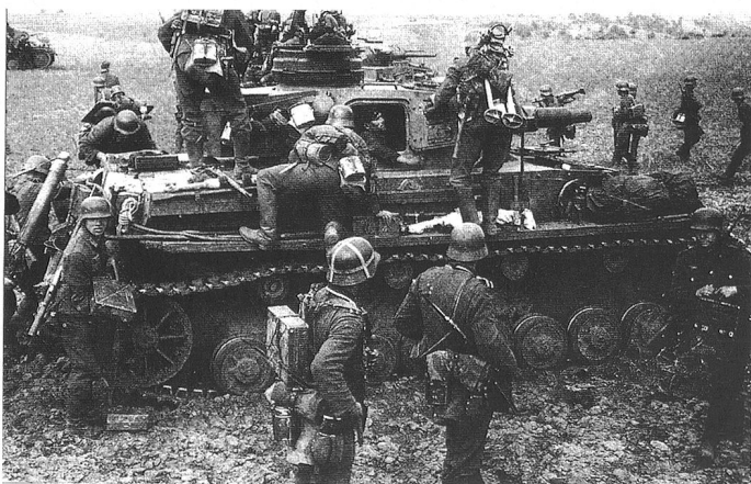
Le PzKpfw IV montre ici son rôle initial d'appui à l'infanterie, grâce à son canon court de 7,5 cm L24. On le voit ici « charger » un groupe de mortiers. Un groupe mitrailleur est en train de prendre place sur l'engin suivant.
