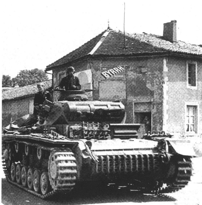
Le PzKpfw III subit d'importantes améliorations à partir de 1940. L'engin est pour le moment encore armé de deux MG34 coaxiales, à droite du canon, en plus d'une arme dans la caisse, servie par l'opérateur radio. Il est armé d'un canon de 3,7 cm L 46,5 à vocation antichar.
