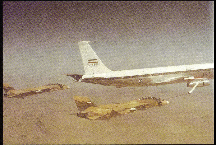
Ravitaillement en vol par un Boeing 707 de l'IRIAF. Cet appareil est généralement connu sous sa dénomination militaire : KC-135.
