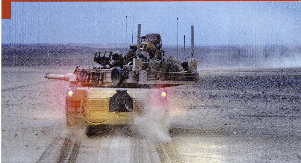
L'US Marine Corps déploie depuis un an la version TUSK du M1-A1 Abrams , disposant notamment de protections renforcées pour l'équipage et d'un déflecteur pour l'échappement à l'arrière. Toutes les photos © USMC.
