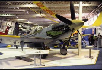
Le *Spitfire* F24 est un des derniers chasseurs à piston ; son moteur fournit 1'478 PS et il vole à 594 km/h. Il est armé de 4 canons Hispano Suiza de 20 mm.
