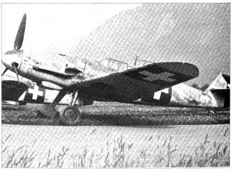
appareils est passée ultérieurement et ceux-ci sont livrés en deux fois. Un premier lot de 30 appareils arrive en Suisse au printemps 1939, et le second, de 50 appareils, au printemps suivant. Ces machines (J-311 à J-390), plus puissantes que les Me-109 D-1, sont des modèles Me-109 E-3 (moteur de 1'100 CV).
