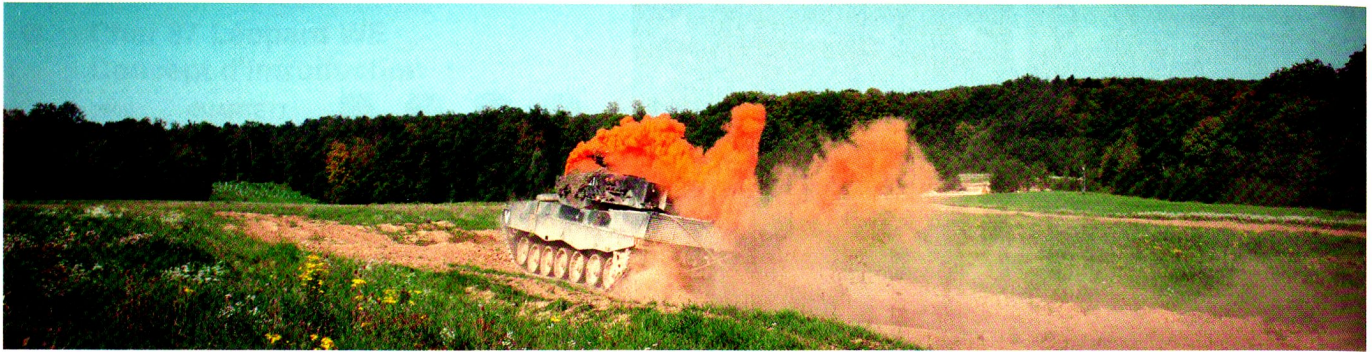
Un char «touché» émet une fumée orange; il est contraint de s'arrêter et son système d'arme est interrompu.
