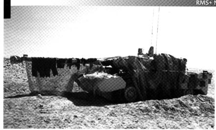
300 chars légers AMX10RC ont servi dans l'armée française. L'engin pèse 17 tonnes et est armé d'un canon de 10,5 cm L48. Il roule à 85 km/h et peut parcourir 800 km.
