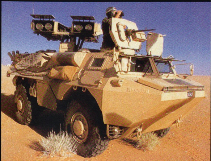
Le Mephisto est un VAB porteur de 4 lance-missiles HOT .
