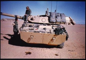
L'AMX 10RC pèse 15 tonnes et est armé d'un canon de 10.5 cm L48 (Vo 800m/s), armé de 38 coups.
