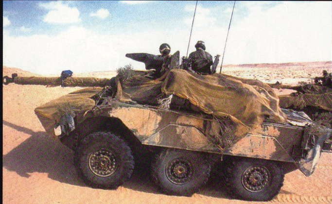
L'AMX 10RC comporte de nombreuses pièces interchangeables avec le véhicule de combat d'infanterie AMX 10P, qui est chenillé et emporte un canon de 20 mm.
