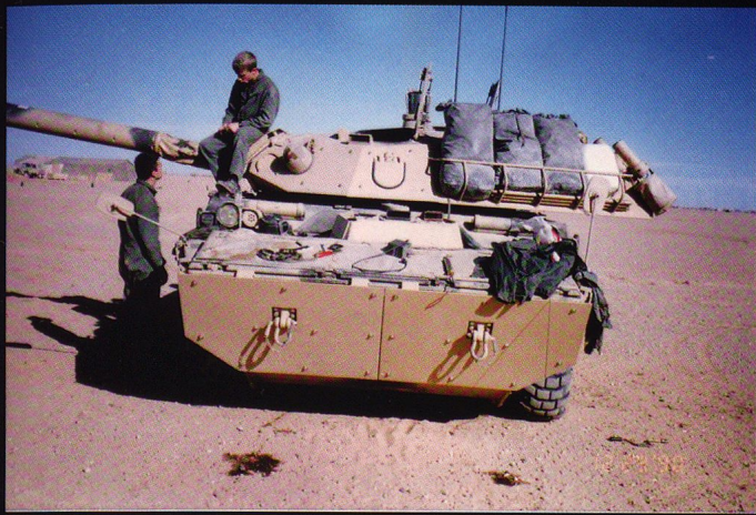
L'AMX 10RC pèse 15 tonnes et est armé d'un canon de 10.5 cm L48 (Vo 800m/s), armé de 38 coups.
