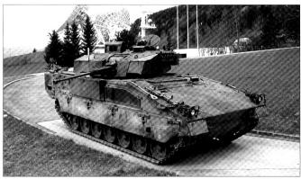
L'Ulan pèse 28 tonnes, roule à 72 km/h et possède un moteur diésel de 720 PS.
