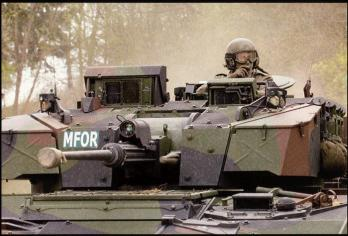
L'ASCOD est équipé d'un canon Mauser de 30 mm et d'un système de conduite de tir Kollsmann. Il emporte 3 hommes d'équipage et 8 grenadiers de chars, pour une masse d'environ 28 tonnes.
