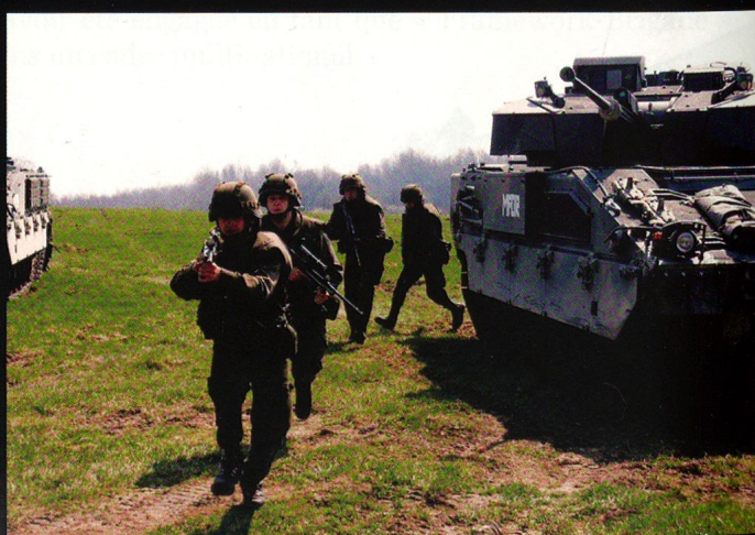
L'ASCOD est équipé d'un canon Mauser de 30 mm et d'un système de conduite de tir Kollmann. Il emporte 3 hommes d'équipage et 8 grenadiers de chars, pour une masse d'environ 28 tonnes.
