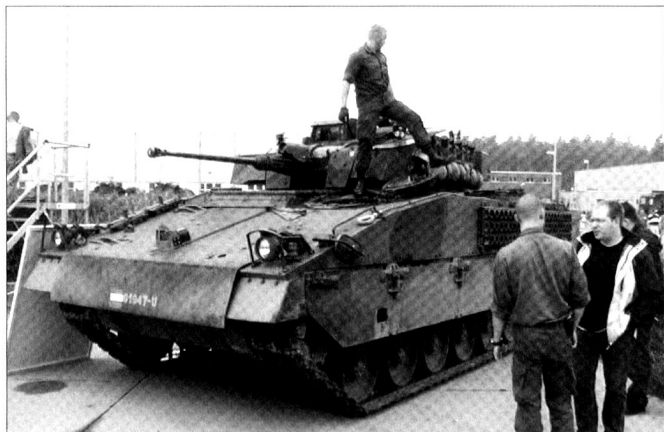
L'expérience des conflits récents démontre la nécessité de développer des blindages additionnels pour ce véhicule, à l'image de ce prototype.
