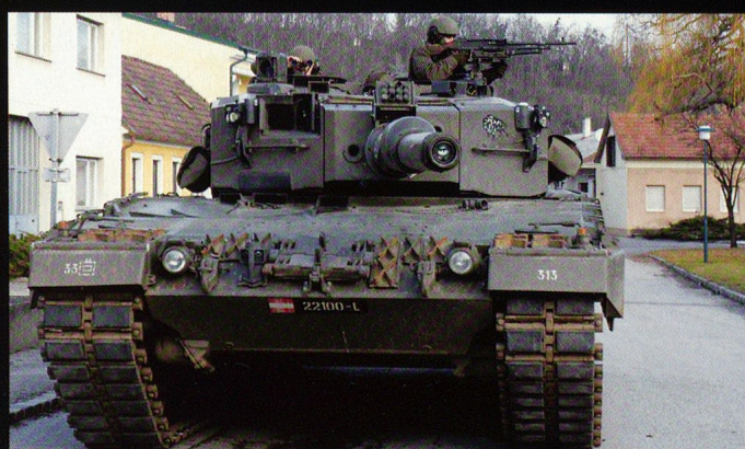
On remarque que les lance-pots nébulogènes néerlandais ont été modifiés, mais selon une disposition différente du système 4 + 4 allemand et helvétique. Les mitrailleuses FN de 7,62 mm ont cependant été conservées.
