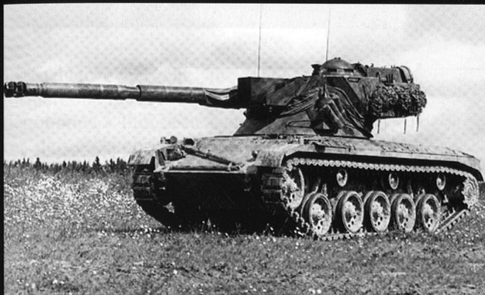
Le chasseur de chars Kürassier (Sk-105) de 17,5 tonnes était apte à se dissimuler et à manœuvrer, dans l'optique d'un combat défensif en terrain coupé.
