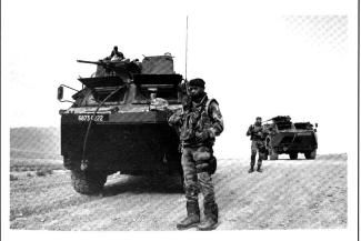
Le Véhicule de l'avant blindé (VAB) a été récemment équipé de surblindages et d'une tourelle télé-opérée de 12,7 mm.
