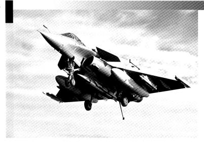
Ci-contre : Le *Rafale* est en mesure d'emporter le missile air-sol moyenne portée (ASMP). L'arme pèse 840 kg, vole à Mach 3, pour une portée maximale de 500 km. La charge nucléaire TN-81 peut être de 100 à 300 Kilotonnes.
