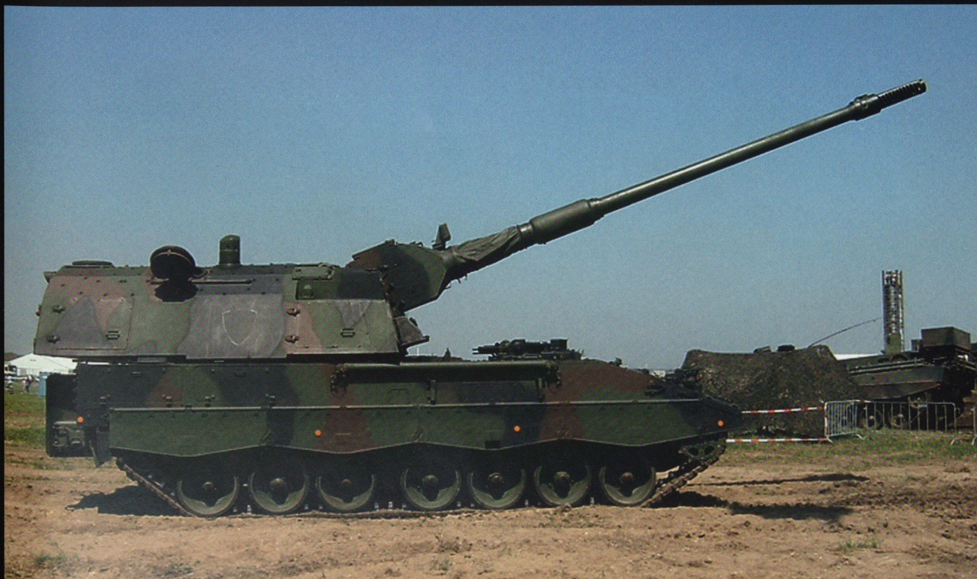
Le Panzerhaubitze 2000, sur châssis Léopard 2 . Il s'agit actuellement du système le mieux protégé et disposant de la puissance de feu la plus élevée. Il est hautement automatisé et a été déployé en Afghanistan par les Pays-Bas.
