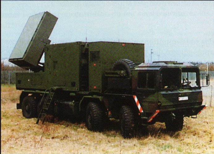
Les radars d'artillerie se sont multipliés depuis les années 1970. Ils servent essentiellement à la détection de mouvements mécanisés et aux calculs pour les tirs de contre-batterie. Aujourd'hui, ces systèmes sont en grande partie remplacés par des radars aériens.
