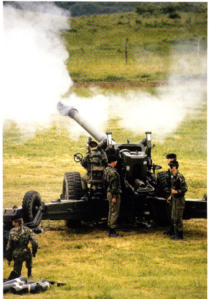
Des pièces d'artillerie tractées disposant de motorisation internes ont été développées jusque dans les années 1980, à l'instar du FH70 britannique.
