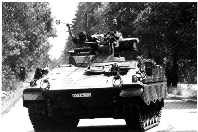
Le Marder 1 A3 et A5 disposent de systèmes de visées jour/nuit, et de meilleures protection latérales, ainsi que contre les mines.
