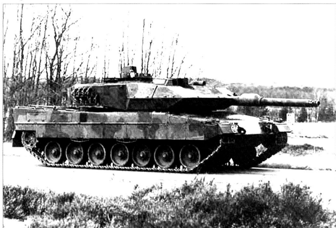
Le Leopard 2 A5 est surblindé et dispose d'une électronique de bord améliorée.
