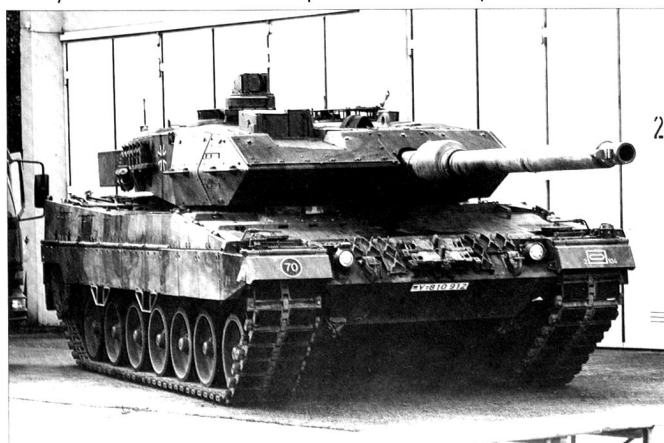
Le Leopard 2 A6 est équipé d'un canon plus long et dispose d'un système de gestion du champ de bataille.
