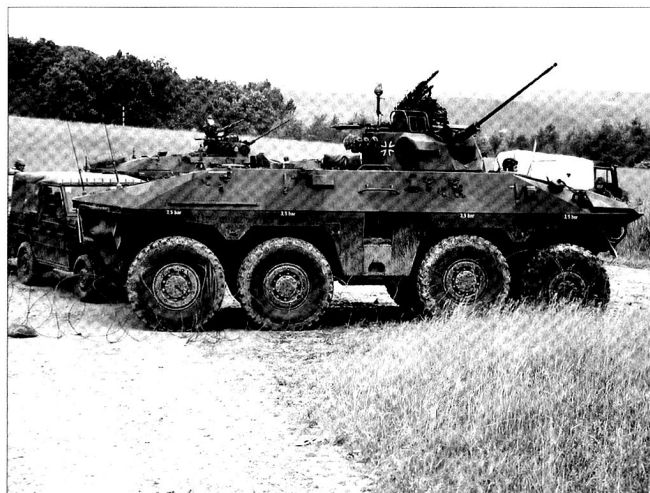
Le Spähpanzer Luchs a été conçu dans la droite ligne des engins de reconnaissance allemands de la Seconde Guerre mondiale. Il était équipé d'une tourelle de 20 mm.
