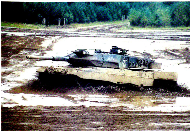
Comme ses prédécesseurs, le Leo 2A6 franchit un gué de 1,5 m sans préparation, et 2,5 mètres avec une brève préparation de 15 minutes.
