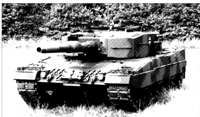
Leopard 2 A4 , doté du camouflage trois tons OTAN et d'un appareil à imagerie thermique (WBG).
