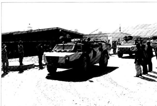
Le Luchs a désormais été remplacé par le Fenneck , un engin plus petit et plus discret, capable d'emporter une suite optronique importante. Cet engin est photographié à Feyzabad, où il sert à transporter un PRT allemand.
