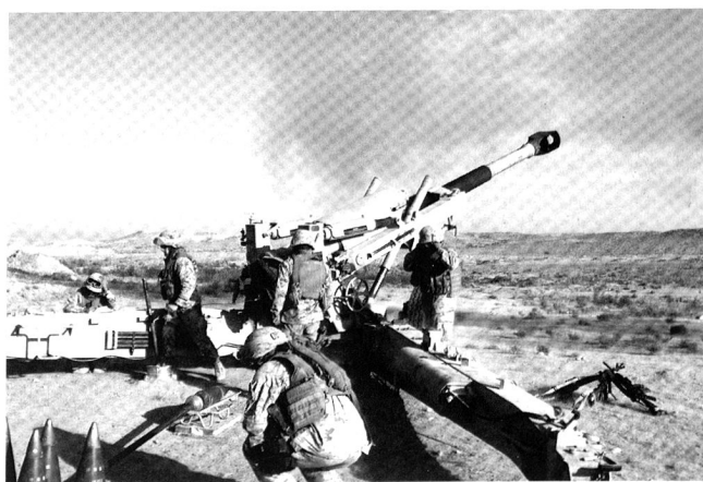
Le M-198 américain est une pièce tractée sans motorisation, afin d'être suffisamment légère pour être hélicoptée.
