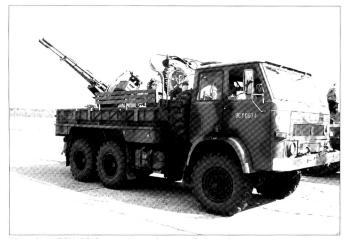
Une pièce ZSU-23-2 montée sur le pont d'un camion.
