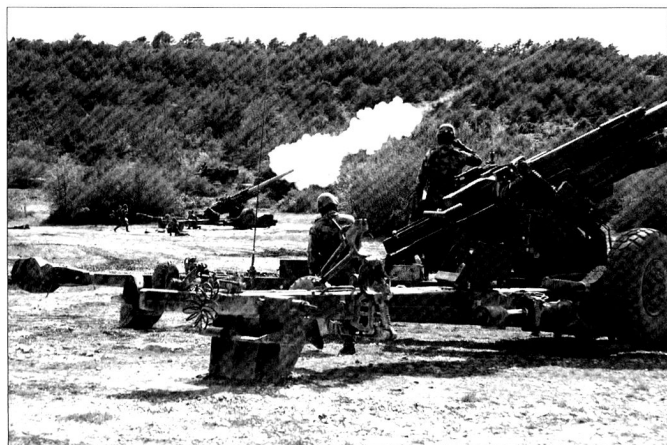
Le 155 TR f1 français est une pièce tractée disposant d'un moteur pour la mise en batterie et les déplacements courts.
