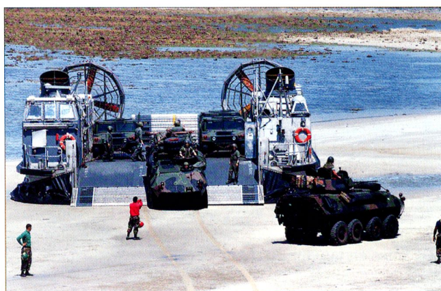
Les transports rapides peuvent s'effectuer avec les LCAC. Chacun peut transporter plus de 60 tonnes de charges.
