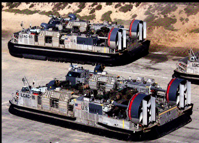
Le LCAC, entré en service en 1986, peut emporter jusqu'à 60 tonnes de charge (75 tonnes en surcharge) à plus de 40 noeuds.
