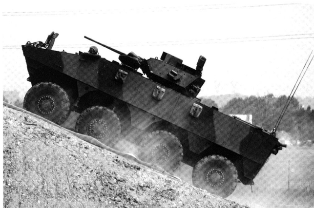
Le VBCI dans sa version de combat d'infanterie, équipé d'une tourelle de 25 mm.
