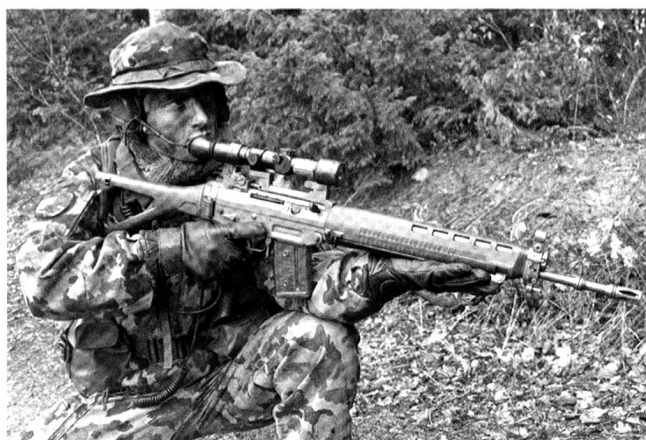
Le fusil d'assaut peut être équipé d'une lunette, pour le tir de précision.
