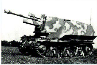
Un 10.5 cm leFH18 auf 39H(f), à savoir un obusier de campagne monté sur le châssis d'un char Hotchkiss H·39, conçu par le Baukommando Becker.
