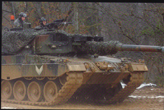
Les chenilles avalent la boue, la neige, ; il faut simplement ajouter des crampons pour la glace... et éviter les routes !
