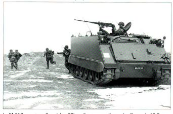
Le M-113 sans tourelleau (char 63) ne dispose que d'une mitrailleuse de 12,7 mm.
