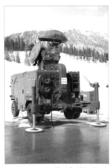
Dans le tir en miroir, le canon est guidé par le dispositif de conduite du tir 75/95.
