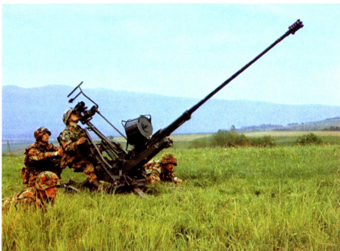
Le nouveau venu : canon DCA 20mm 54 Oerlikon, qui servira jusque sous l'A 95.
