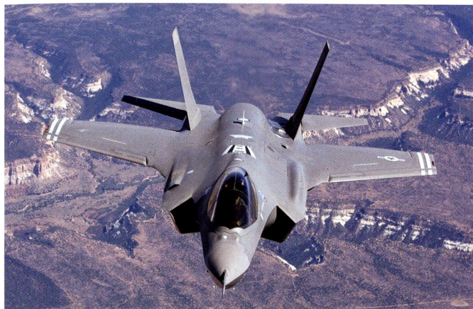
Le F-35 A est la version conventionnelle développée pour l'USAF. Il dispose d'un canon de 25 mm interne, dans un renflement au-dessus de la prise d'air gauche.
