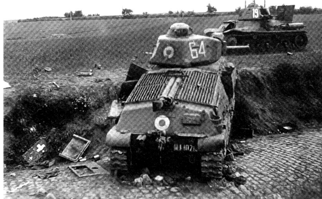
Le char français le plus réussi en mai 1940 était le Somua S35, employé au sein de divisions légères mécaniques (DLM) - l'équivalent français de la Panzerdivision.
