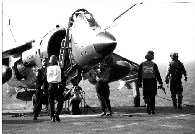
Le Shar FRS Mk.1 est reconnaissable par son tube de pitot et sa perche de ravitaillement escamotable.
