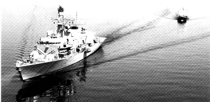
La frégate type 23 HMS Portland (F79) est équipée de missiles antinavires Harpoon et de missiles de défense aérienne Sea Wolf VLS .
