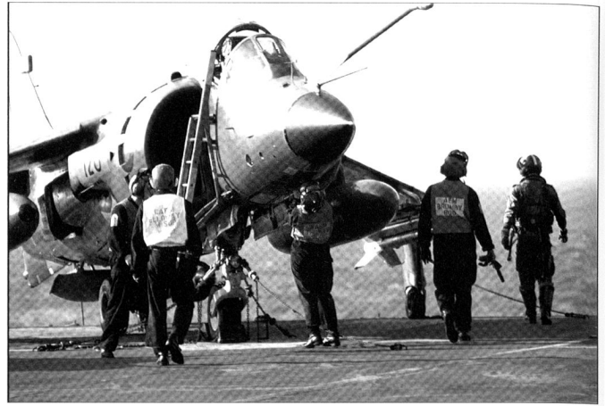
Le Shar FRS Mk.1 est reconnaissable par son tube de pitot et sa perche de ravitaillement escamotable.
