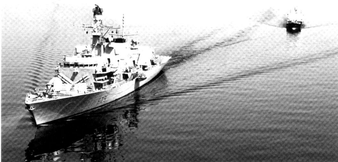
La frégate type 23 HMS Portland (F79) est équipée de missiles antinavires Harpoon et de missiles de défense aérienne Sea Wolf VLS.
