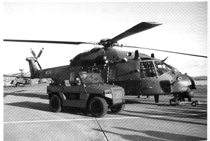
L'hélicoptère de transport NH90 est capable d'emporter des véhicules légers tous terrains.
