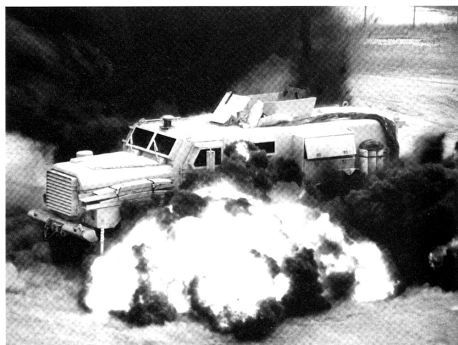
MRAP lors d'un test de résistance aux explosifs.
